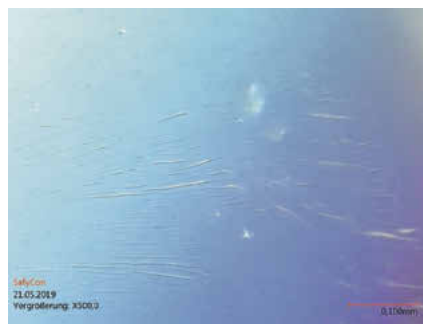
▲ Bild 5 | Materialfehler einer neuen, blisterfrischen Monats-Silikonhydrogel-Kontaktlinse mit Hydraglyde
