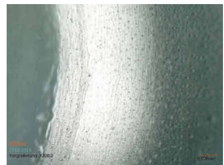
▲ Bild 18 | Fluor-Silikon-Acrylat, individuell gedreht hergestellt, abrasiv (manuell) gereinigt
