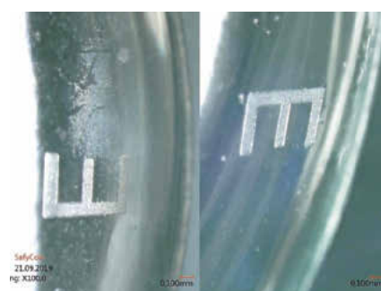
▲ Bild 12 | Links: Silikonhydrogel-Kontaktlinse mit vom Hersteller empfohlener KombiLösung, einen Monat getragen und gereinigt; rechts: nach einem Monat, mit SafyCon regeneriert
