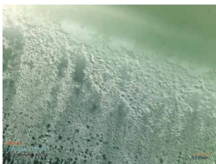
▲ Bild 7 | Erodierter Oberfläche einer getragenen Silikonhydrogel-Kontaktlinse
