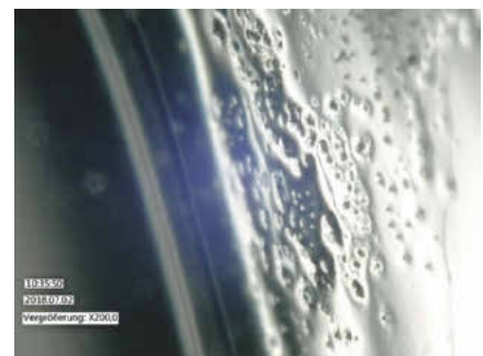
▲ Bild 6 | Weiche, schwammartige Struktur der Oberfläche eines getragenen Bio-Hydrogels, durch manuelle Oberflächenreinigung erodiert
