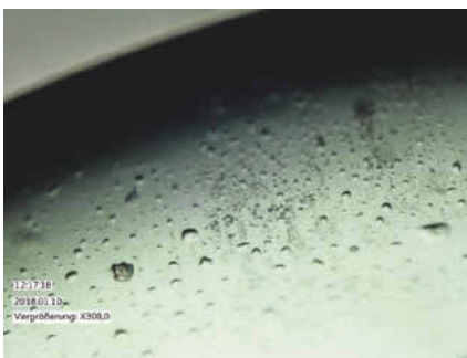
▲ Bild 16 | Außenfläche eines formstabilen Fluor-Silikon-Acrylates: schlecht benetzt, „unkomfortabel“
