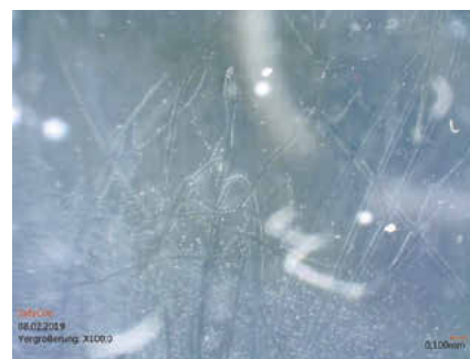
▲ Bild 9 | Nach der manuellen Reinigung mit KombiLösung einer Silikonhydrogel-Kontaktlinse
